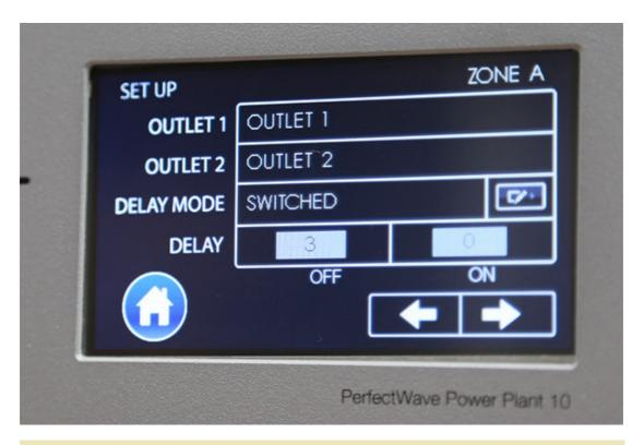
**P10** 有個很方便的功能,就是可自定每組輸出的開機模式,5 組都可各自定義。圖中表示 A 區的 1 號與 2 號插座定為 SWITCHED 模式,當 P10 面板電源鍵開啟時,A 區立刻開啟,但 關閉電源時 A 區會延遲 3 秒才關閉,延遲時間可調整。
