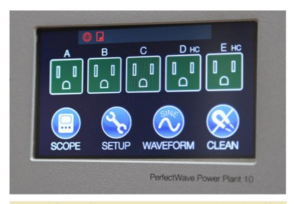
P10 開機後便會進入這個畫面,表示背後  $A \times B \times C \times D \times E \pm 5$  組 10 個插座的狀態,綠色表示該組插座目前處於開啟狀態。直接壓按螢幕上的插座即可關閉該組插座,因此每一組都可個別控制。下方 4 個圓圈可進入各種功能選項。
