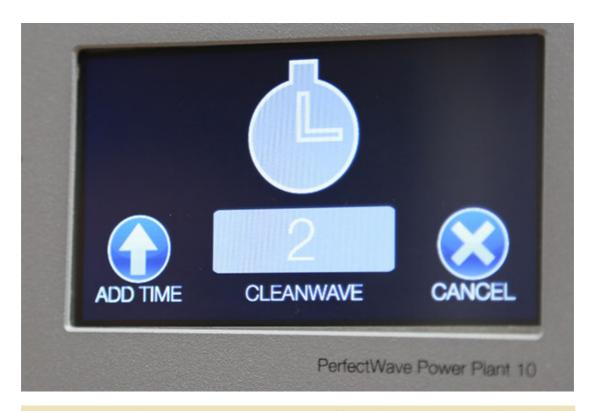
這是 Power Plant 的另一項特異功能,CleanWave。據資料表是,CleanWave 可幫助連接的器材的變壓器消磁。使用時,請將連接的器材保持開啟,但不必播放出音樂,然後輕觸面板顯示幕首頁上的 CLEAN 功能,P10 便會開始 CleanWave 並自行倒數,約 10 秒即可完成。
