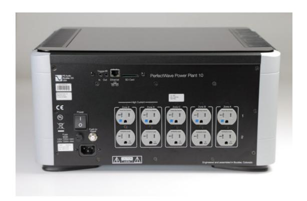
P10 背板提供 5 組共 10 個電源插座,可以看到左邊的 E 區與 D 區是大電流設定,專供綜合 擴大機或後級使用。還可以看到插座在未使用時,插孔內有擋板會自行密封,具有防塵功能。
