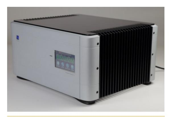
PS Audio 認為運用被動元件組成濾波電路來淨化電源的方式無法把失掉的能量加回電源,因此不能徹底解決交流市電的根本問題,因此開發了 P10 Power Plant 電源處理器。它的基本架構和一部後級擴大機差不多,運用放大方式再生電源。
