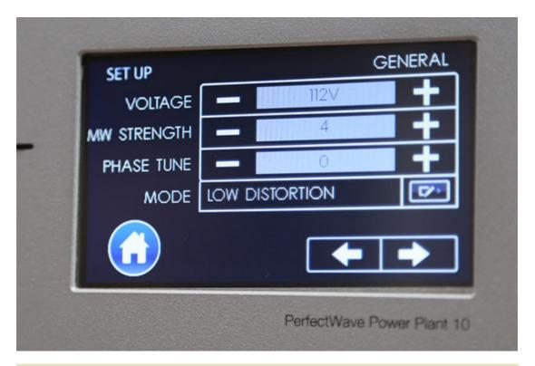
輕觸面板首頁的 SET 圖示,即可進入設定頁面。首先是幾項基本卻重要的設定。地 1 個是 VOLTAGE 輸出電壓,可增減你想要的輸出電壓,電壓不同,聲音表現也不一樣畫面中已調 至 112V。第 2 個是 MW STRENGTH,就是調整 multiwave 的強度,有 1 至 6 段可調。第 3 是 PHASE TUNE 相位的微調功能。第 4 是 MODE 電源處理的形式,有 LOW DISTORTION 與 HIGH REGULATION 兩種,如果你家電源的相對狀況還不錯,可選用 LOW DISTORTION,但如果家裡電源品質較差,例如電壓時常不穩定,則可選用 HIGH REGULATION。
