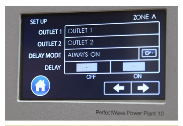
ALWAYS-ON模式:不論面板電源是否開啟,只要背後的電源開關打開,A區就會保持電源輸出電源,而且是經過處理後的乾淨電源。善用上述這6種模式,你可以指定5組插座不同的開/關機方式,然後讓音響器材的電源保持開啟,用P10依序開機即可,從此以後不必再麻煩的——開機或關機了。
