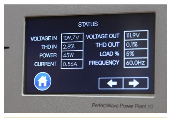
P10 也可以顯示目前的電力品質,以及經 P10 處理後的電力品質,例如輸入前與輸出後的電
